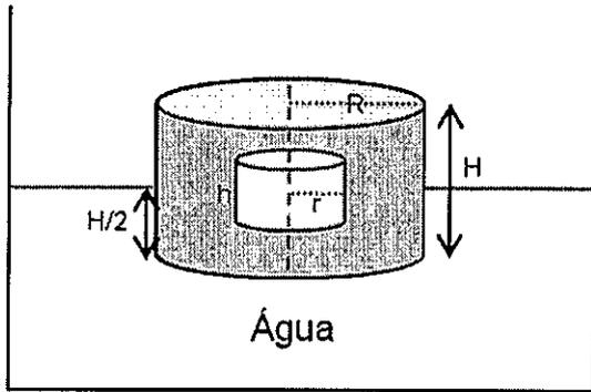
A figura acima apresenta um cilindro sólido de raio  $R$  e altura  $H$ , flutuando em um recipiente contendo água, com metade do seu volume submerso. Considere que no interior do cilindro existe, concêntrica a ele, uma cavidade cilíndrica de raio  $r$  e altura  $h$ . Sabendo que a densidade do material de que é feito o cilindro é igual à densidade da água e que  $H = 1,5h$ , calcule a razão  $r/R$  e assinale a opção correta.
