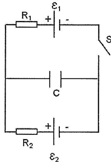
A figura acima apresenta um circuito com um capacitor  $C$ , duas fontes ideais  $\varepsilon_1$  e  $\varepsilon_2$ , dois resistores  $R_1$  e  $R_2$  e uma chave  $S$ . Considere que, inicialmente, a chave  $S$  permaneceu aberta por um longo tempo de forma que o capacitor adquiriu uma carga  $q_0$ . Se a chave  $S$  for fechada e assim permanecer também por um longo tempo, a variação percentual da carga no capacitor em relação à carga inicial  $q_0$  é de:
